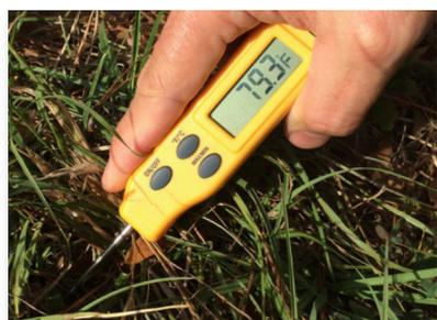
Le thermomètre de poche numérique est un thermomètre robuste muni d'une sonde pliante et facile à transporter. Il lit la température du sol en 10 secondes.
