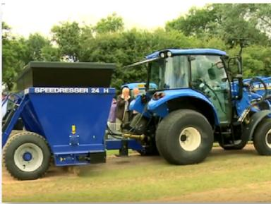
Le Speedresser 24 est un sableur en nappe gros débit conçu pour tous les matériaux de top-dressing. Les pneus basse pression minimisent le risque de marquage et de compaction. Le Speedresser 24 requiert un tracteur d'au moins 75cv. Il est entraîné par prise de force 540 tr/min via un agitateur et deux rouleaux jumelés. Il a une capacité d'épandage de 2mm à 75mm de matériau en un seul passage. Idéal pour les terrains de sports et les golfs.
