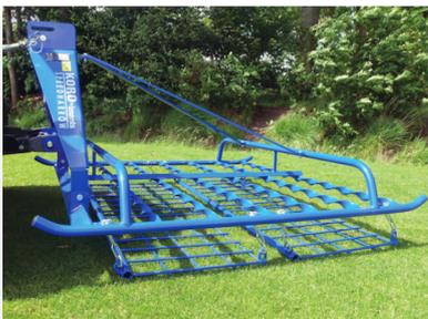
Le Speed Harrow s'attelle par une fixation portée 3 points et possède un système de relevage hydraulique des 2 ailes pour la version 4100. Des barres amovibles de nivellement peuvent être fixées sous le châssis principal. Elles sont destinées à racler après un top dressing léger sur gazon ou à niveler rapidement les surfaces après les matchs.
