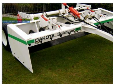
La benne rabot est équipée d'un système hydraulique pour contrôler la hauteur, d'une inclinaison bilatérale hydraulique sur chaque roue et d'un réglage hydraulique des dents et d'une patte de boulonnage sur les plaques latérales. Elle existe en 3 largeurs de travail et peut être adaptée pour un nivellement laser.
