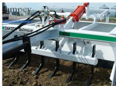
Dakota propose une gamme de bennes rabot / lames de nivellement trainées pour modifier et mettre à niveau sols et sable. Idéal pour l'aménagement paysagé, la mise en forme du terrain pendant la construction, pour remettre en état les terrains de golf et terrains sportifs. Avec des dents défonceuses le travail sera plus agressif permettant ainsi de décompacter des sols très durs.
