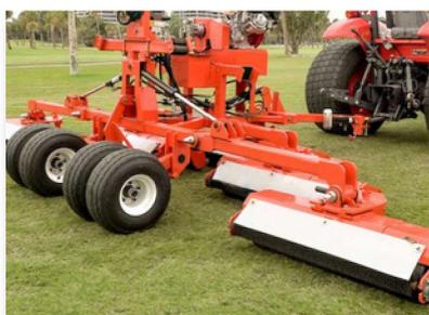
La lisseuse STR180 se monte derrière un tracteur. Elle permet de lisser les fairways très rapidement grâce à ses 5 rouleaux et ses 4,5 mètres de large. Elle utilise l'hydraulique du tracteur pour le relevage des rouleaux et de ses roues de transport. Les rouleaux ont la même conception non agressive que tous ceux de la gamme Salsco. Pour les golfs exigeants, c'est l'outil qui leur permettra d'améliorer la qualité de roue et de portance sur les fairways.
