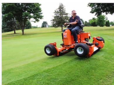
Ce rouleau peut aller d'un green à l'autre sans remorque ni véhicule. Montées sur vérins hydrauliques, ses roues se relèvent pour permettre le travail et s'abaissent ensuite pour le trajet jusqu'au green suivant. Les temps d'opération sont diminués de 30% par rapport à un rouleau remorqué. Les rouleaux de gros diamètre présentent une excellente motricité, quelle que soit la pente, et ne stressent pas le gazon grâce à leur design.
