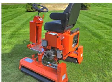
Le HP5.5 est un rouleau de green de grande motricité grâce à ses 4 petits rouleaux entraînés. Ils permettent à la lisseuse de ne jamais patiner, préservant ainsi la surface des greens. C'est la lisseuse de la gamme avec la plus faible pression au sol. Les deux supports de rouleaux du cadre latéral peuvent flotter sur le terrain, ce qui permet d'obtenir une surface parfaitement lisse. Il peut être équipé d'options : brosse, kit de spiker et extension de pédales. Livrée avec remorque de transport.
