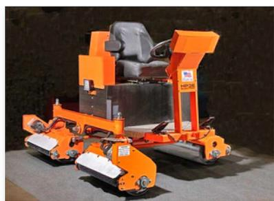
Le rouleau vous permet de travailler silencieusement et plus rapidement grâce à ses trois rouleaux qui couvrent une largeur de travail de 1,85m à chaque passage. Il offre les mêmes spécifications que le HP11-III mais avec une motorisation électrique et un contrôle électronique du déplacement pour préserver les greens. Il est équipé d'une batterie au lithium de 48V avec chargeur intégré. Il est livré avec sa remorque de transport, un kit phare et peut être équipé de spikers.
