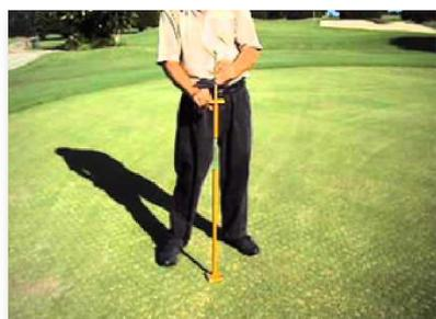
Le Pénétromètre de chute est un outil qui permet de mesurer la compaction de surface par un procédé simple. La tige métallique est lâchée d'une hauteur constante et la pointe vient pénétrer le sol. Le haut de la tige est gradué permettant de mesurer la pénétration dans le sol.
