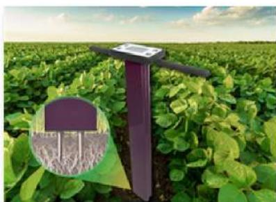
L'humidimètre Field Scout TDR250 mesure l'humidité dans le sol. L'humidité mesurée est le pourcentage en volume d'eau dans le sol (VWC). Des sondes de différentes longueurs (3,8 cm, 7,5 cm, 12 cm et 20 cm) peuvent être montées pour effectuer les mesures à différentes profondeurs.
