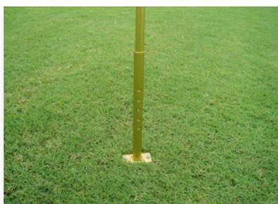
Cette sonde permet de lire le taux d'humidité du sol. La lecture est analogique grâce à une aiguille.
