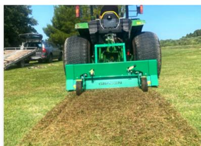
Le GBS 1200 est un défeuteur de 1,2 mètres, monté en 3 points derrière un tracteur. Grâce à ses lames au carbure de tungstène qui tournent dans le sens opposé à l'avancement il est idéal pour travailler dans le feutre épais et les gazons tropicaux. Il s'utilise sur les départs et fairways de golfs et les terrains de sports.
