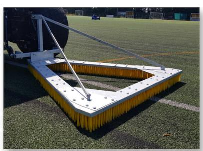
La brosse triangulaire montée sur tracteur est idéale pour redresser le poil et répartir le remplissage de surface afin d'obtenir une finition uniforme et sûre des terrains synthétiques.
