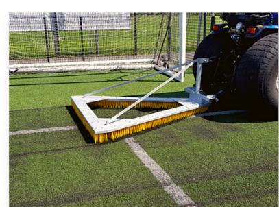
La brosse triangulaire Campey peut être utilisée sur les terrains stabilisés et les terrains synthétiques 3G, pour enlever les éraflures et les empreintes de pas, redistribuer le remplissage et promouvoir un gazon vertical. La brosse peut être utilisée sur des tracteurs de 18 ch et plus. Les sections de brosse individuelles peuvent être facilement remplacées lorsqu'elles sont usées.
