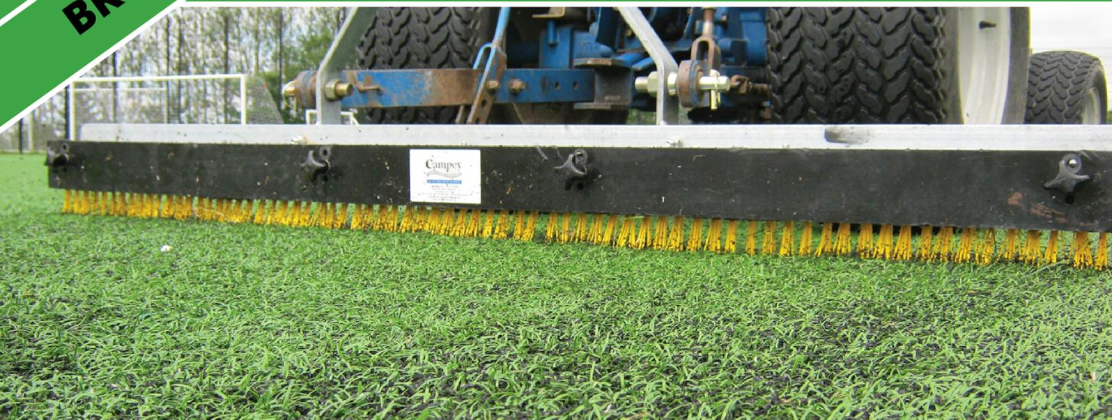
La synthoflex brush est une brosse pour gazon synthétique montée sur un attelage à 3 points convenant aux tracteurs compacts de 15 ch. La brosse Synthoflex est conçue pour une utilisation régulière sur toutes les surfaces artificielles afin d'aider à redresser les poils et à niveler les granulats de caoutchouc. La rigidité des poils peut être réglée pour s'adapter aux surfaces grâce à une plaque coulissante qui réduit leurs mouvements.
